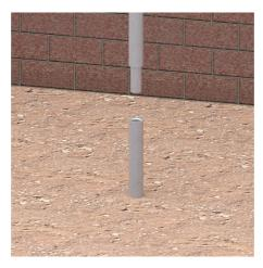
4. Вынув забивную головку (NE1403), необходимо нанести слой электропроводящей смазки на нижнюю часть (цапфу) верхней секции заземлителя (NE1211) и вставить в верхнее отверстие ранее забитой нижней секции.
