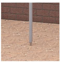
2. Установку заземлителя следует начать с нижней секции NE1212. Заостренный конец стержня упрощает погружение заземлителя в землю.
