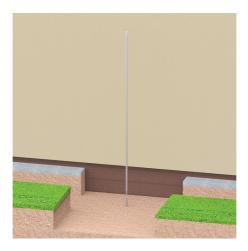
1. Перед началом установки необходимо выкопать в земле траншею глубиной не менее 0,5 метра на расстоянии 1 метр от объекта.
