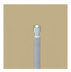
3. В верхнюю часть стержня заземления вставляем забивной винт (NE1403). Нижнюю секцию стержня (NE1212) необходимо вбить в грунт таким образом, чтобы от забивного винта до дна траншеи оставалось порядка 20 см.
